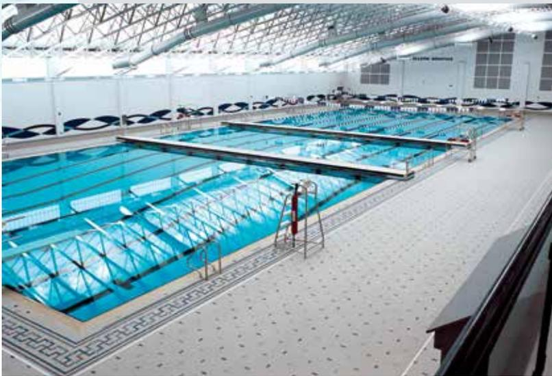
Eine Trennwand ermöglicht die Unterteilung eines Schwimmbeckens in verschiedene funktionelle Bereiche. Myrtha Pools mobile Trennwände werden über ein patentiertes, einem Schiffsruder ähnlichem Bewegungssystem, auf zwei am Beckenumgang installierten Schienen bewegt. Eine automatische Variante ist ebenfalls verfügbar. Verankerungen für die Startblöcke, Schwimmlinien, Geländer sowie weitere Optionen wie Sicherheitsstufen und integrierte Griffleisten sind ebenfalls lieferbar.
